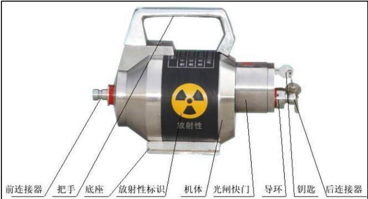
图 9-13 源屏蔽容器（贮源容器）外部结构组成图
